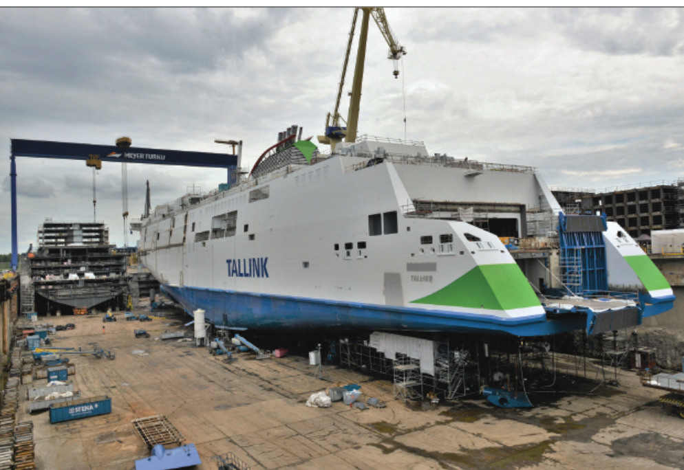
Vor der Flutung des 365 m langen Baudocks: Letzte Arbeiten am Unterwasserschiff der „Megastar“.
