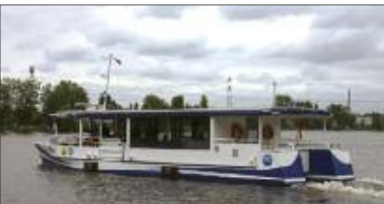
Abbildung 3: Fährbär, eine von vier Berliner Elektrofähren, deren Akkus über Solarstrom und Landanschluss geladen werden. (Foto: Dr. Hochhaus)
