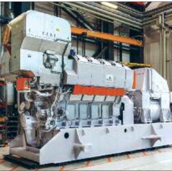
Die mittelschnelllaufenden Dieselmotoren der neuen Baureihe W 31 von Wärtsilä setzen in ihrem Leistungsbereich (4880 bis 9760 kW) neue Maßstäbe hinsichtlich Wirtschaftlichkeit. Das betrifft sowohl den Kraftstoffverbrauch wie die Wartungsintervalle, die im Durchschnitt auf die doppelte Zeit verlängert werden konnten.
