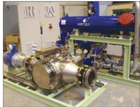
Das Ballastwasser-Behandlungssystem „Aquarius UV“ von Wärtsilä arbeitet mit einem Filter und ultravioletttem Licht und ist für Strömungsgeschwindigkeiten zwischen 50 und 1.000 m 3 /h geeignet. Die Zeit für den Filterelementwechsel liegt zwischen fünf und sieben Jahren.
