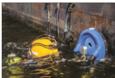
Ein Taucher bei der Reinigung eines Schiffsrumpfes mithilfe der Cavi-Blaster™-Technologie.
