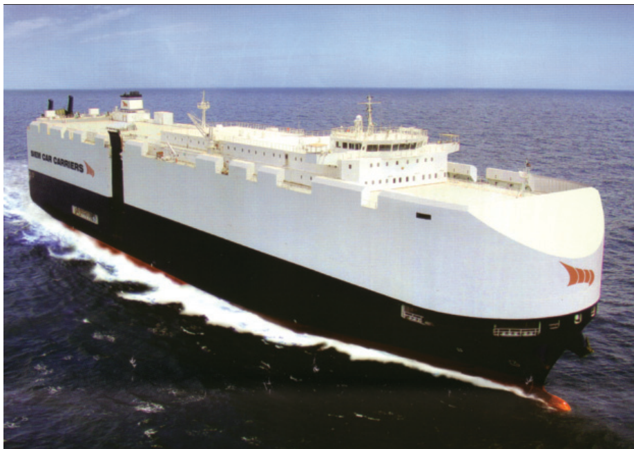
Die beiden ca. 200 m langen und 36 m breiten Carcarrier mit zwölf Decks werden Kapazitäten für je ca. 4500 Fahrzeuge (7000 CEU) aufweisen.
