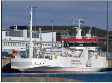
Abbildung 3: Bunkerschiff „Seagas“. (Quelle Sirius Shipping)
