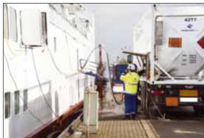
Betankung der MS „Ostfriesland“ mit Flüssigerdgas. Foto: Marlies Menger
