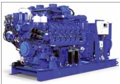
Bordaggregat von Rolls-Royce Power Systems mit einem 16-Zylinder-Motor der MTU-Baureihe 4000 für den Betrieb mit variabler Drehzahl und einer maximalen Leistung von 3.440 kW. Der nutzbare Drehzahlbereich reicht von 500 bis 2.100 min -1 Foto: Rolls-Royce
