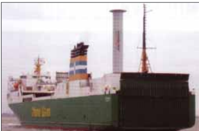
Die „Estraden“ ist das zweite RoRo-Schiff mit Flettner-Rotoren.
