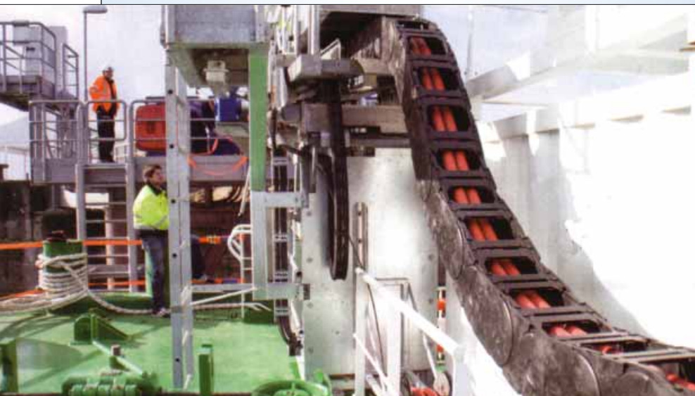
Die Ankopplungstechnik für die Verbindung zwischen Barge und Kaikante lieferte Igsu.
