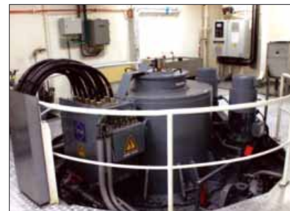
Abbildung 12: E-Antriebsmotor für einen der vier Ruderpropeller. (Foto: Dr. Hochhaus)
