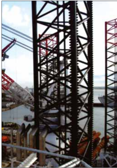
Abbildung 6: Jedes der Hubbeine wird von 24 Zahnrädern angetrieben. (Foto: Dr. Hochhaus)
