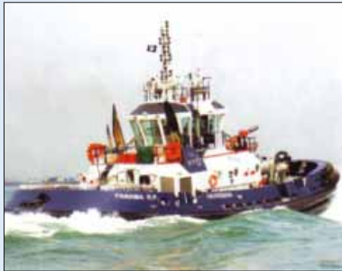
Die 2010 als erste Einheit der ASD-Schlepper-Serie abgelieferte „Calovébora“ ist mit zwei Schottel SRP 1515-Ruderpropellern ausgerüstet. Foto: Cheoy Lee Werft
