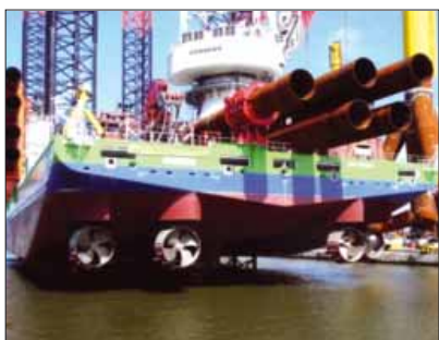
Abbildung 2: Schottelantriebe der „Innovation“. (Foto: Dr. Hochhaus)
