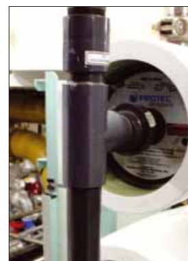
Abbildung 15: Die Wickelmembranen dienen der Entsalzung des Meerwassers. (Foto: Dr. Hochhaus)
