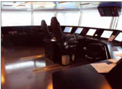
Abbildung 17: Das Brückenpult für den normalen Fahrbetrieb. (Foto: Dr. Hochhaus)
