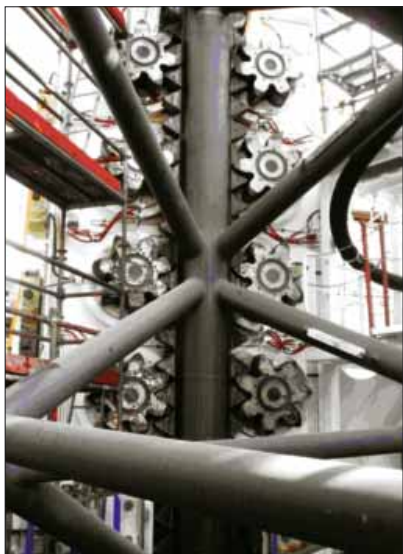
Abbildung 8: Antrieb der Hubbeine. (Foto: Dr. Hochhaus)
