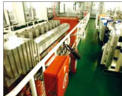
Abbildung 4: Sechs Dieselmotoren erzeugen den Strom. (Foto: Dr. Hochhaus)
