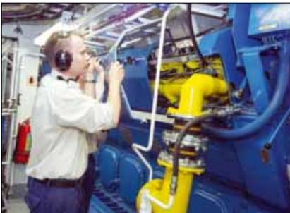
Die Maschinenbesatzung kontrolliert einen Gas-Antriebsmotor auf der weltweit ersten RoPax-Fähre MS „Stavangerfjord“.
