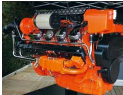
**SCANIA's neuer XPI Motor mit Common-Rail-Technik leistet nun 846 kW bei 2.300/min.**
