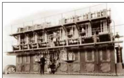
Die „Selandia“ und ihre vier Schwesterschiffe erhielten jeweils zwei direkt umsteuerbare Achtzylinder-Kreuzkopf-Viertaktmotoren mit einer Wellenleistung von je 1.000 PS bei einer Drehzahl von 140 min<sup>-1</sup>.
