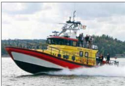
Mit 2x 846 kW bei 2.300/min über 2 KaMe-Wa Rolls Royce FF 550 Jets beschleunigt das Boot bis zu 39 kn.
