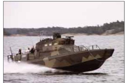
Das Watercat M18 AMC, ein Combat Support Service Vessel (CSSV), wird von 2 neuen Scania-XPI-Common-Rail-Motoren mit einer Gesamtleistung von 1.692 kW über 2 weiterentwickelte Rolls-Royce-40A3-Waterjets angetrieben.
